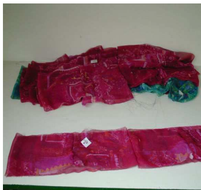
Figura 2 : esempio di manichetta. Consente di confrontare, avvicinandoli, i centri cimosa e le eventuali diverse tonalità.
