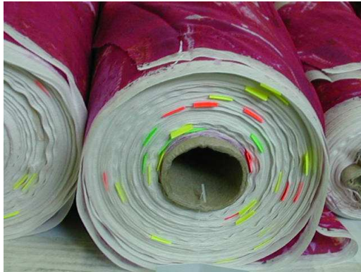
Figura 5 : esempio di pezza già controllata. Durante la stesura del tessuto è possibile controllare le zone eventualmente non utilizzabili per la confezione.
