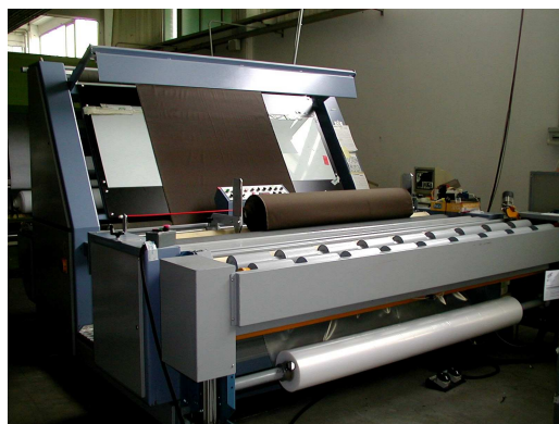
Figura 1: macchina verificatrice con imbustatrice. Il nylon protegge il materiale durante il trasporto.
