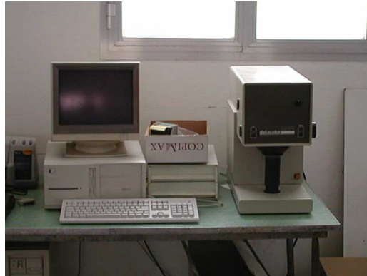
Figura 7 : spettrofotometro. E' in grado di verificare oggettivamente eventuali differenze di colore con il campione.
