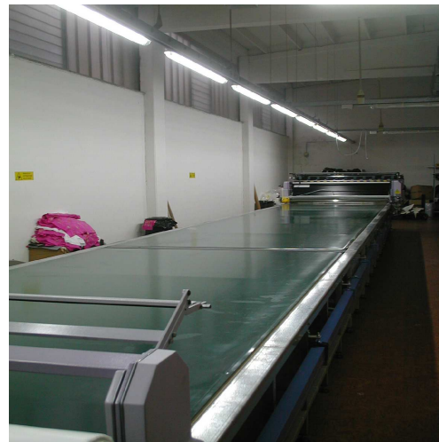
Figura 12 :linea di stesura dotata di conveyor
