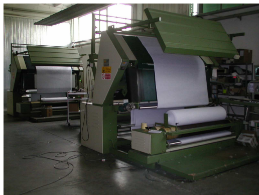
Figura 4 : sistema per la ricerca delle imperfezioni nel tessuto. Con il materiale in verticale è possibile far risaltare i difetti sia in ordito che in trama.
