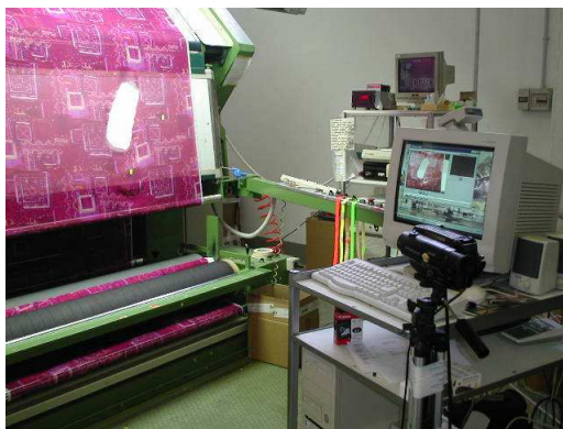
Figura 6 : attraverso la trasmissione di immagini via linea ISDN si può visionare il prodotto in tempo reale
