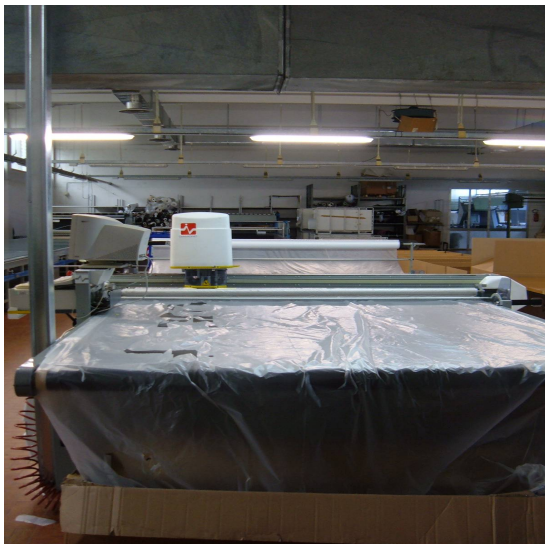
Figura 11 : scorcio del taglio automatico Investronica DIAMOND
